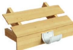
Данный вариант крепления используется только для водосточных систем Döcke PREMIUM и STANDARD.
