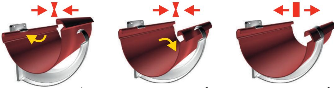
Для фиксации желоба в пластиковых кронштейнах или соединительных элементах заведите желоб в зажимы со стороны карниза (1) и, слегка надавливая на переднее ребро желоба в сторону карниза, опустите его в кронштейн или соединительный элемент.
