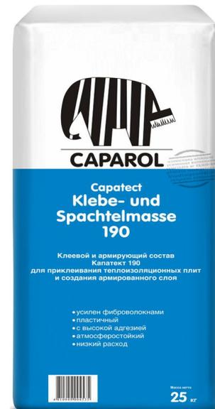
необходимости пройти зубчатой теркой 8x8 мм), затем прикладывается стеклосетка СТ-Gewebe 650 с перекрестом не менее 10 см и слегка втапливается, после чего еще раз зашпатлевывается методом «мокрое по мокрому» таким образом, чтобы обеспечить полное закрытие сетки. Общая толщина покрытия должна составлять примерно 3-4 мм.
