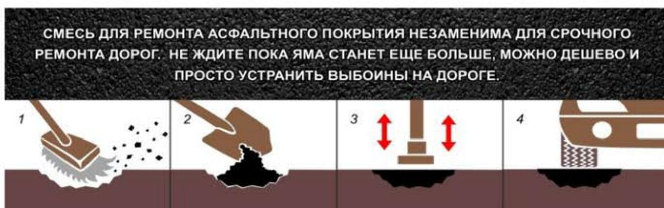
Ремонт поверхности (не глубокая яма) с использованием готовой асфальтной смеси:
