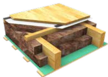
Перекрытие по балкам над проветриваемым подпольем
