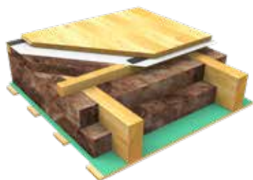
Перекрытие по балкам над проветриваемым подпольем
