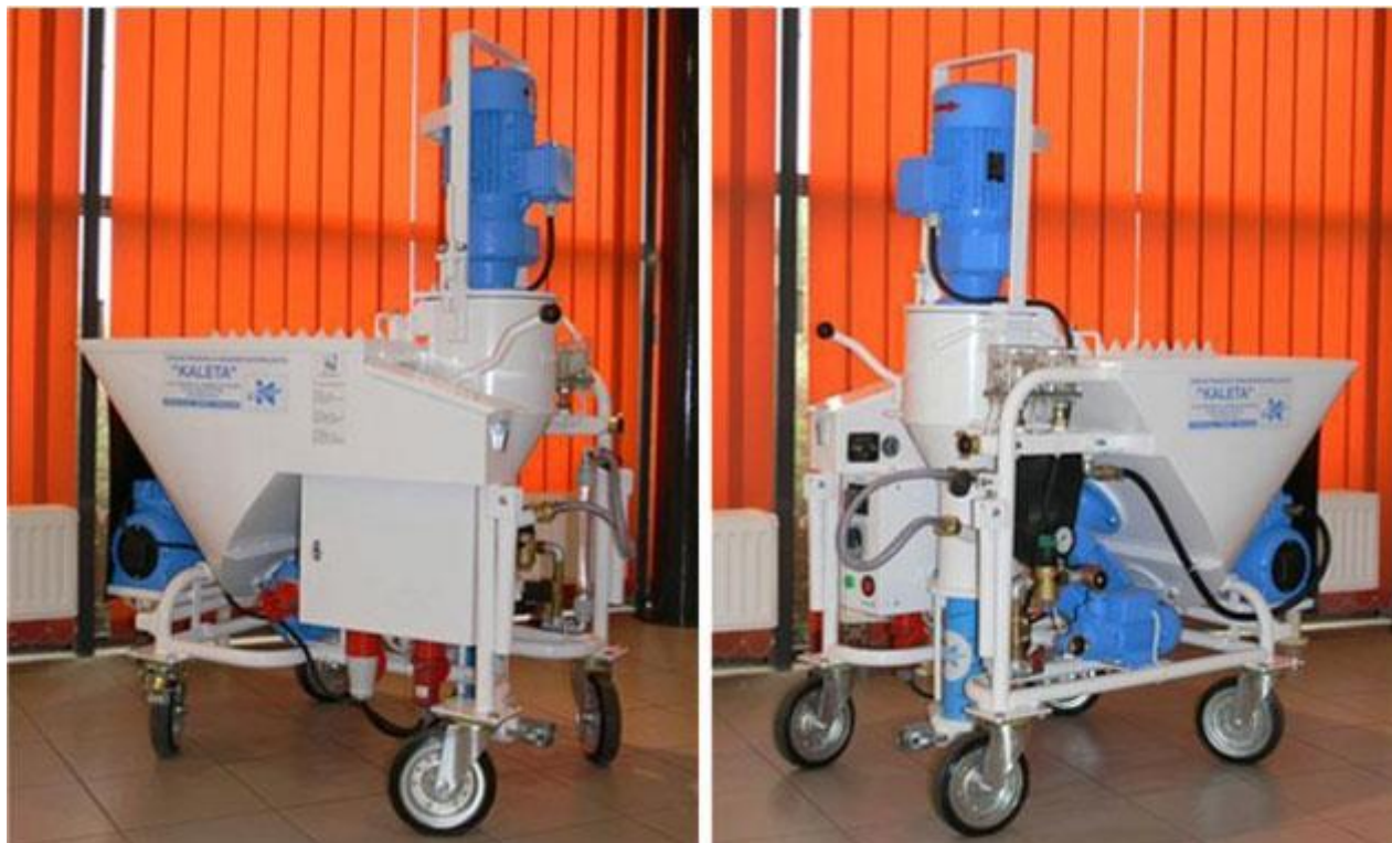
Рисунок 3 - Внешний вид штукатурного агрегата типа «Kaleta»
